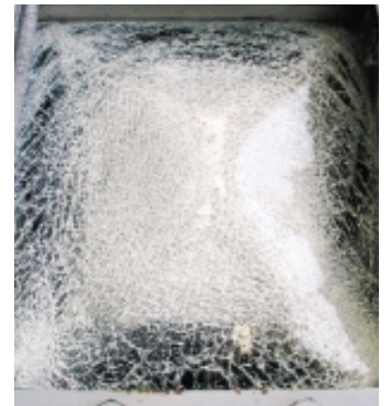
Test de résistance à une déflagration : EN 13541
